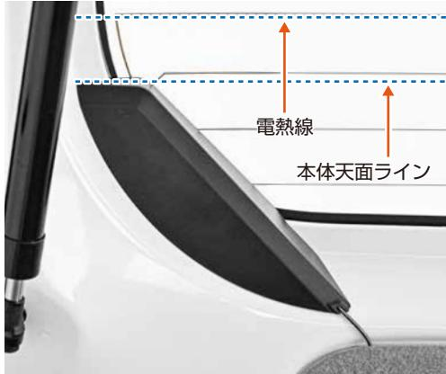
④ガラスの電熱線と本体天面が平行になるようにしながら、本体を車体形状に合わせるように位置調整してください。
