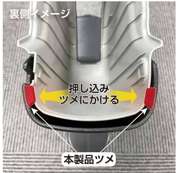
⑤図のように後部下、内側から車体側サイドブレーキカバーを広げるように押し込み、本製品内側の左右2箇所のツメにしっかりとひっかけ固定します。以上で取り付け完了です。
