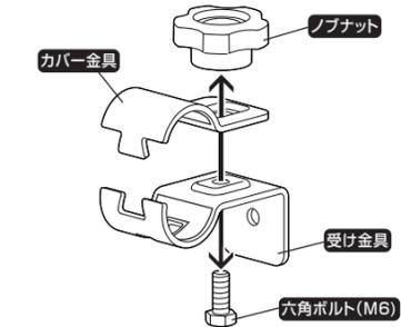
②受け金具を下記のように車体ネジ穴に取り付けます。取り付けの際はプラスドライバーをご使用ください。
