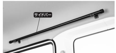
④取り付けがある受け金具にカバー金具を組み合わせて乗せ、下図のように六角ボルトとノブナットを回してサイドバーを固定し完成です。
