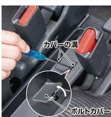
② マイナスドライバーの先端をカバーの溝に差し込み、押し上げるようにして外してください。
