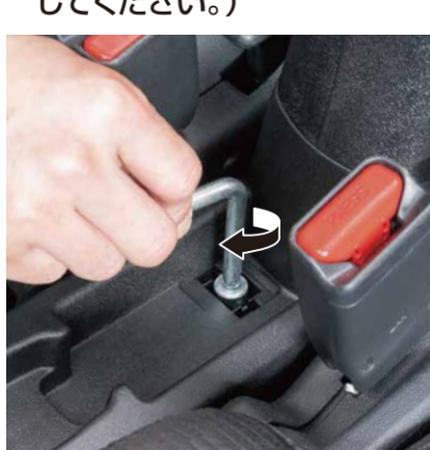
⑥ 取り外したボルトをセットして、レンチでしっかりと締め付けてください。
