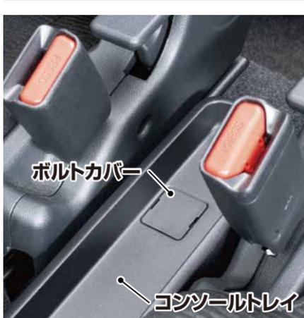
① コンソールトレイ後ろ側のボルトカバーを確認してください。
