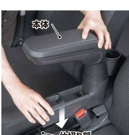
⑤ 本体をコンソールトレイにセットしてください。(コンソールトレイの仕切り部分に被せる)
