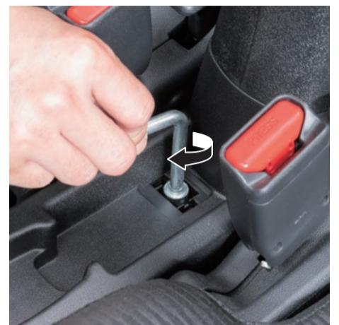
⑥取り外したボルトをセットして、レンチでしっかりと締め付けてください。
