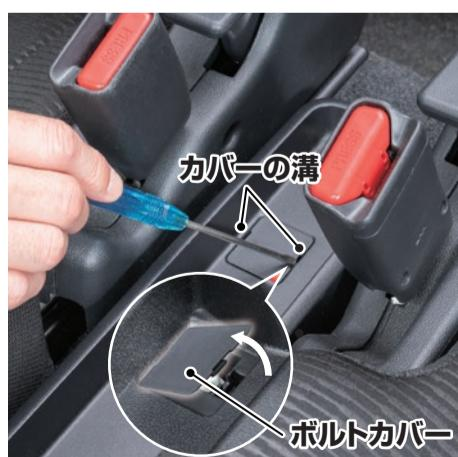
②マイナスドライバーの先端をカバーの溝に差し込み、押し上げるようにして外してください。
