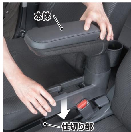
⑤本体をコンソールトレイにセットしてください。(コンソールトレイの仕切り部分に被せる)
