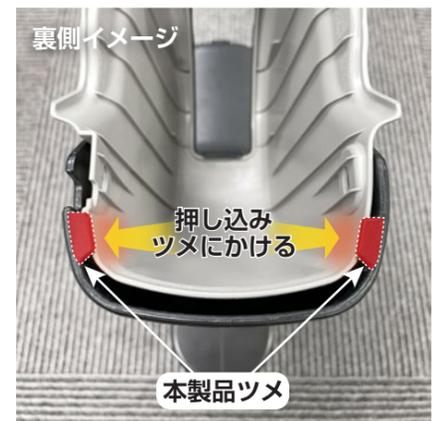
⑤図のように後部下、内側から車体側サイドブレーキカバーを広げるように押し込み、本製品内側の左右2箇所のツメにしっかりとひっかけ固定します。以上で取り付け完了です。
