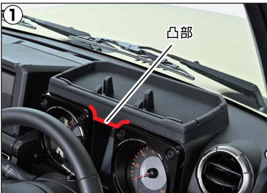
本製品前部の凸部がメーターの間のくぼみに合ようにして、ダッシュボードに置いてください。
